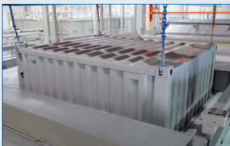
KTL -Grundierung im Tauchbecken
